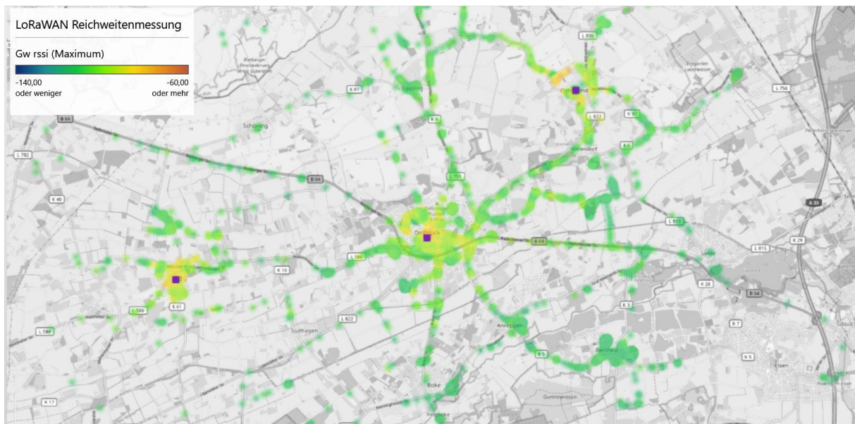
Abbildung 11 LoRaWAN Outdoor-Netzabdeckung Heatmap
