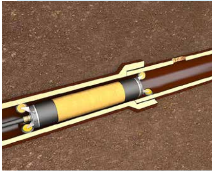
(a) Reparatur mit Kurzlinern Positionierung des Packers mit dem Kurzliner
